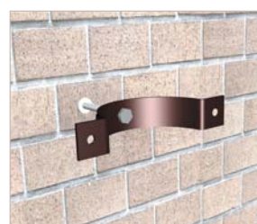
Obr. 19 – montáž objímek svodu
