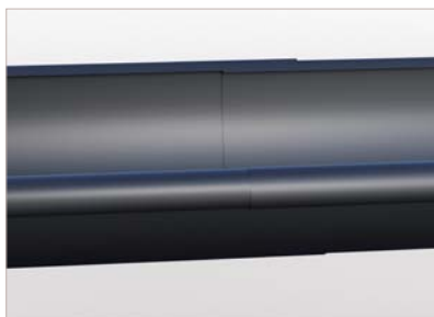
Obr. 5 - Žlaby se do sebe pevně osadí. V případě spoje bez dilatační spojky (dilatační úsek do 12 m) se snýtuji. Při použití dilatační spojky se nenýtuje!
