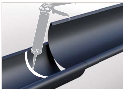
Obr. 4 - V místě přeložení se provede podtmelení tmelem NOVApplast nebo podobným.
