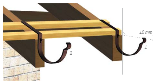
Obr. 7 – umístění háků do krokví, ohyb od objektu
